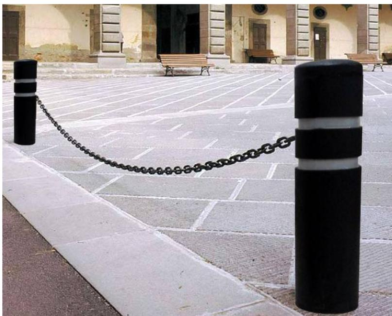
I dissuasori modello "T1" e "T2", vengono realizzati con una miscela di polimeri omogenei riciclati da cavo elettrico. Possono essere resi meglio visibili mediante l'applicazione di fasce rifrangenti o l'incastonatura di elementi in vetro. Eventuali strati di verniciatura possono essere applicati con prodotti ad alta visibilità (microsfere di vetro in post spruzzato).
